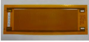
Fig. 2 Macro-fiber composite (MFC) actuator.<sup>1</sup>
